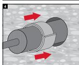
Poser le bandage coupe-feu Hilti CFS-B sur les deux faces dans l'ouverture à une profondeur de 62,5 mm (voir le marquage sur le bandage).
