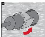
Enrouler le bandage coupe-feu Hilti CFS-B autour de l'isolation. Assurer le bandage avec une bande ou un fil en acier ( $\geq 0,7$  mm).
