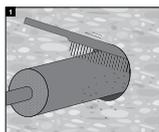
Nettoyer l'ouverture. Le matériau autour de l'ouverture doit être sec, sain et exempt de poussière ou de graisse.
