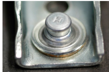
Empreinte du piston sur la rondelle
