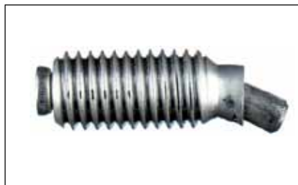
Déformation plastique du goujon X-BT
