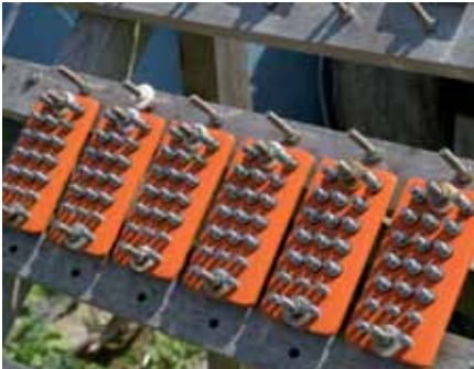
Banc d'essai atmosphérique marin avec spécimens d'essai X-BT posés.
