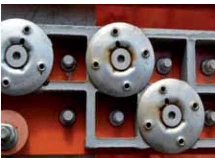
Banc d'essai en eau de mer avec les spécimens d'essais posés (X-BT avec et sans les coupelles X-FCM).
