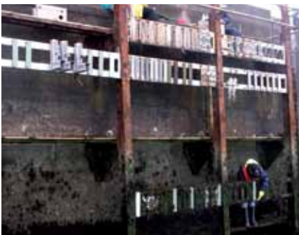
Banc d'essai en eau de mer avec les spécimens d'essais posés (X-BT avec et sans les coupelles X-FCM).
