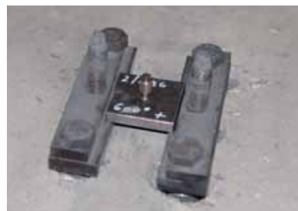
X-BT sur une plaque de base de 8,0 mm
