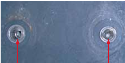
Trous percés après 90 jours d'essai au brouillard salin et après arrachement des goujons X-BT. Ces trous apparaissent propres et aucune trace de corrosion n'est visible.
