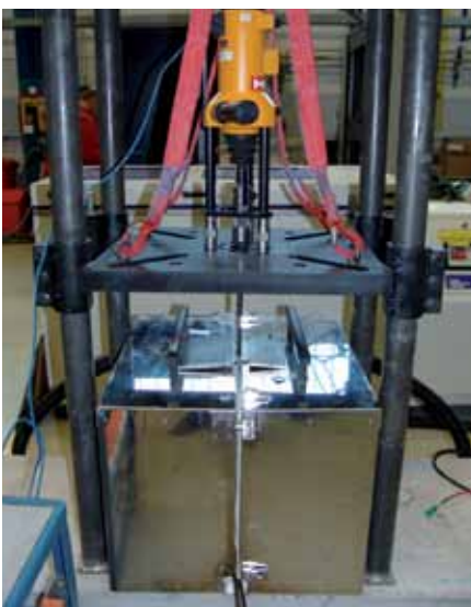
Cylindre de traction dans le four
