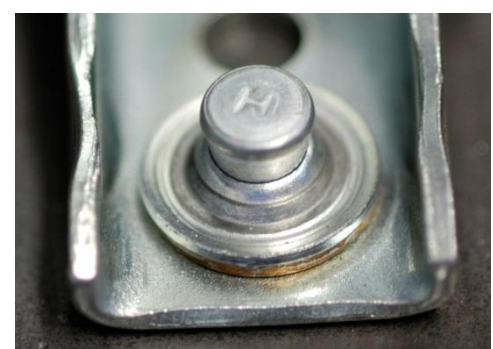
Empreinte du piston clairement visible sur la rondelle
