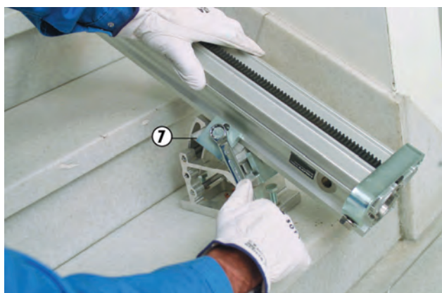
Монтаж рельсовой опоры для угловой/ступенчатой резки
